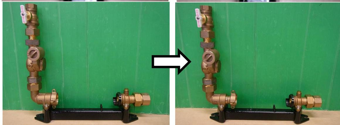
★代用管もしくは水道メータを取り外した状態にて、ハンドルをSの方向へ回転させるとスライドホルダが緩みます。
