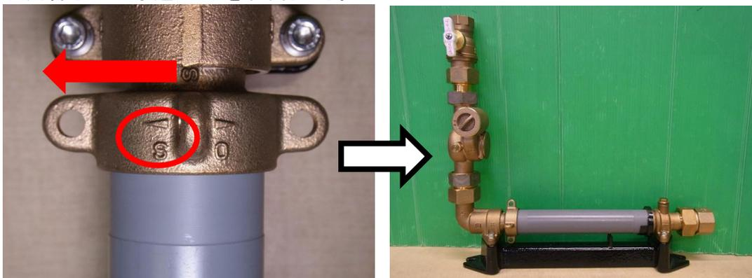
★スライドホルダをSの方向に手で回して、水道メータを取り付けて下さい。
