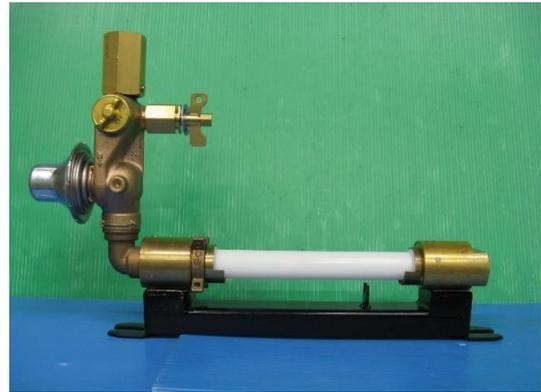
★ハンドルをSの方向に手で回して、代用管もしくは水道メーターを取り付けて下さい。
