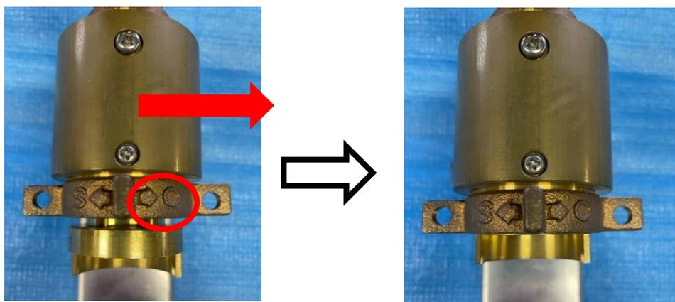
★スライド管の縮み方向への移動が完全に終わるまでハンドルを**Oの方向**へ回転させます。
